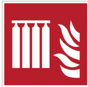
Sistema fijo de extintores en serie
