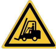
Peligro carritos elevadores y otros vehículos industriales
