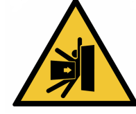
Peligro de aplastamiento del cuerpo
