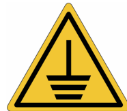
Toma de tierra
