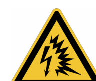
Peligro arco eléctrico
