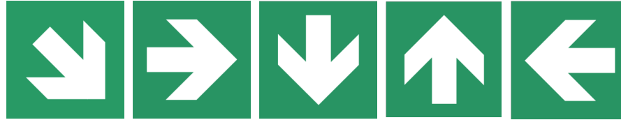
Kierunek drogi ewakuacyjnej
