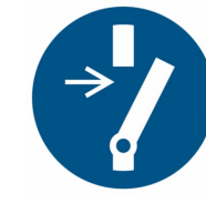
Verplicht uitschakelen voor aanvang werkzaamheden
