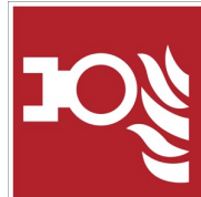
Aansluitpunt droge blusleiding
