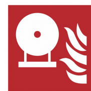
Rögzített tűzoltókészülék palack
