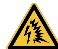
Arc flash hazard
