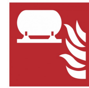
Fest eingebaute Feuerlösch- Einrichtung
